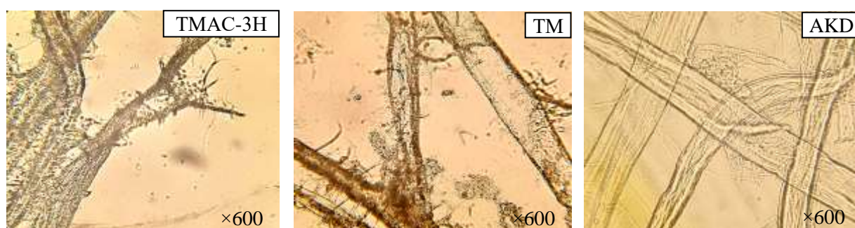
Рисунок 10 – Микрофотографии бумажной массы, изготовленной из суспензии ЦСБЛ, содержащей проклеивающие комплексы в виде ЧДФ разработанной эмульсии ТМАС-3Н и традиционно используемых ТМ и АКД
